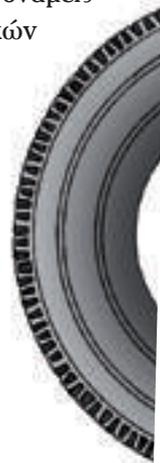
βάθος πέλματος των ελαστικών με χειμερινό πέλμα είναι 4,0 mm. Τα ελαστικά των λεωφορείων είναι τύπου R (Radial-ακτινωτά) και TUBELLES (χωρίς αεροθάλαμο). Τα δίδυμα ελαστικά δέχονται μέγιστη φόρτιση 7750 kg. Υπερφόρτωση κατά 20% μειώνει την αντοχή του ελαστικού κατά 30% και ελαττώνει την αποτελεσματικότητα της πέδησης.
