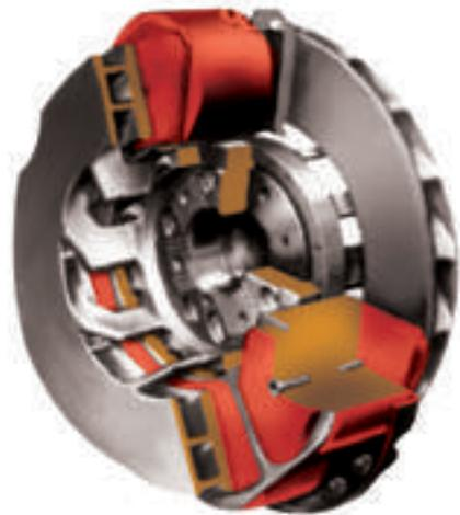
Σχήμα 2.23 Υδραυλικός επιβραδυντής.
