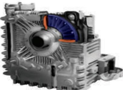
**Σχήμα 2.22.** Υδραυλικός επιβραδυτής
