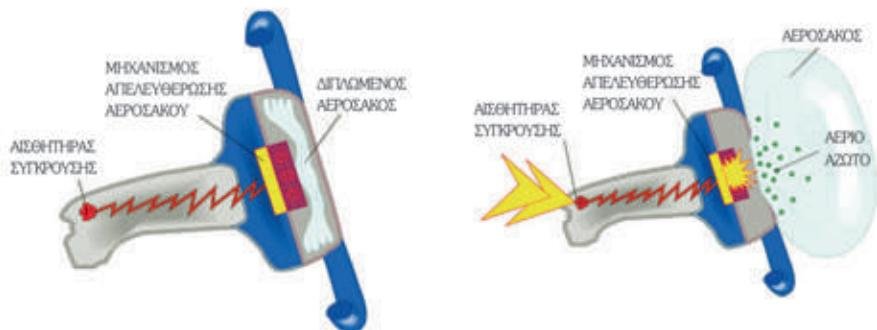
Σχήμα 4.1. Λειτουργία αερόσακου.
